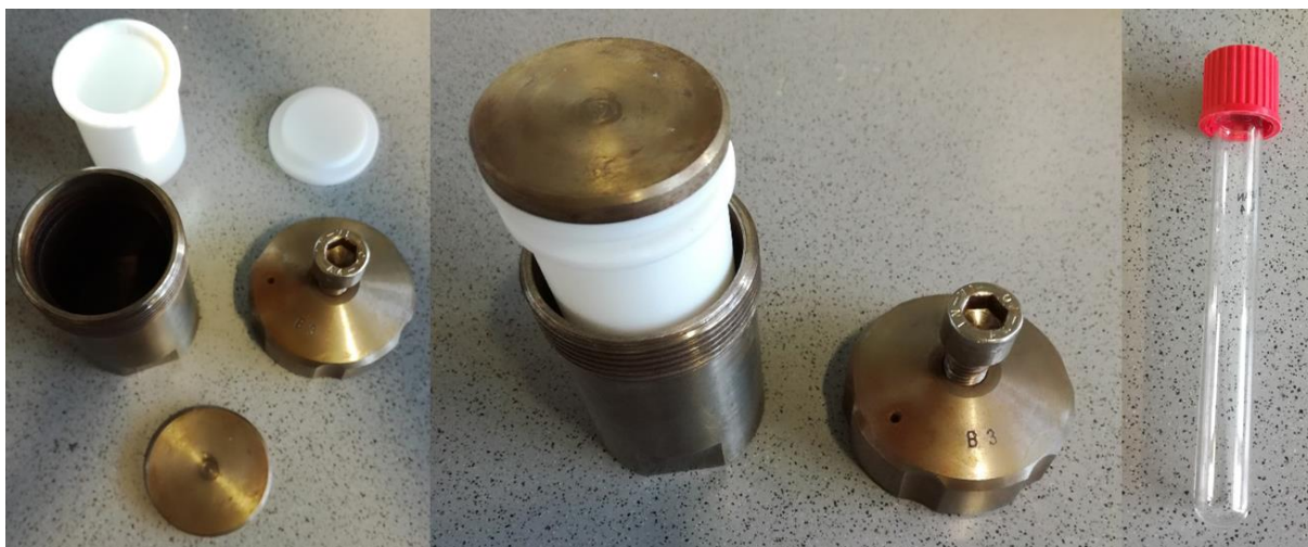
Abbildung 02. Lichtbild eines gebräuchlichen 30 mL Stahlautoklaven mit Tefloneinsatz (links) und 7 mL Glasgefäß (rechts) zur Durchführung von Solvothermalsynthesen.
