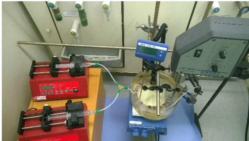
Abb.18: Reaktor 1 bestehend aus Spritzenpumpen, einem Reaktor aus gewickeltem Teflonschlauch und einem Ölbad als Heizquelle.
