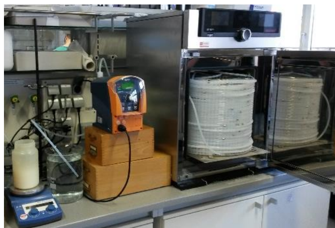
Abb.19: Reaktor 2 bestehend aus einer Magnetmembranpumpe, einem Reaktor aus gewickeltem Teflonschlauch und einem Umluftofen als Heizquelle.
