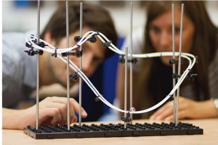
Abbildung 4: "Die unendlich laufende Achterbahn": Eine Murmel, am höchsten Punkt losgelassen, rollt auf Grund der Energieentwertung nicht wieder bis zum höchsten Punkt zurück.
