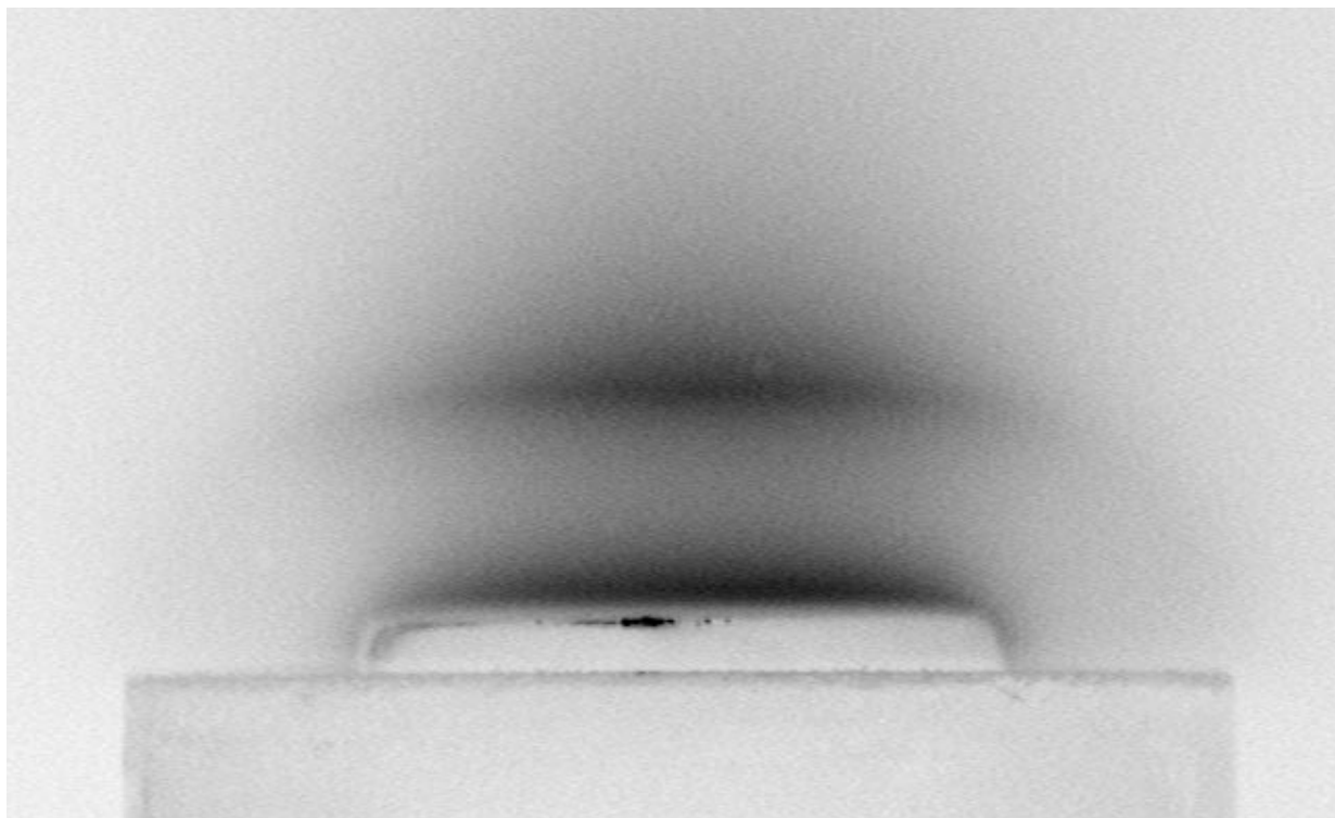
Abbildung 7.11: Negativbild der Kathode. Die dunklen Bereiche sind mit hoher Emissionsintensität verbunden. Die Parameter lauten p = 10\text{ mbar} , U_0 = 1000\text{ V} und I_0 = 5\text{ mA} . Der Tantalstab und das Glasröhrchen sind gut zu erkennen. Zur besseren Sichtbarkeit des Glasröhrchens wurde die Entladung von außen mit einer Glühlampe beleuchtet. Das Ende des Fallgebiets ist durch ein kräftiges Leuchten in einem Abstand von ca. 2.0\text{ mm} zu erkennen. Als Vergleich hierzu dient der Durchmesser des Tantalstabs. Er beträgt 6\text{ mm} .
