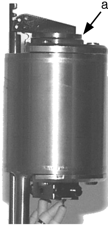
Abb. 2.16: Die Knudsenzelle im Originalzustand (a = unzureichender Shutter-Zellen-Abstand), geschlossen.
