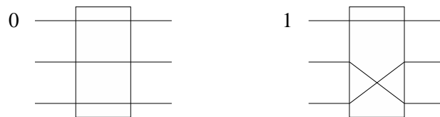
Abbildung 4.14: Der Fredkin-Schalter. Er besteht aus einem Knoten mit drei Ein- und Ausgangsbits. Der Wert des obersten Eingangsbits wird immer auf das oberste Ausgangsbit kopiert. Hat das oberste Eingangsbit den Wert 0 (linkes Bild), werden die beiden unteren Eingangsbits auf ihre entsprechenden Ausgangsbits kopiert. Hat das oberste Eingangsbit dagegen den Wert 1 (rechtes Bild), werden die beiden unteren Eingangsbits vor dem Kopieren auf die beiden unteren Ausgangsbits vertauscht.
