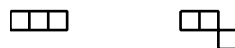
Abbildung 11.3: Unterscheidungsproblem der Ordnung zwei. Beide Muster haben drei Pixel. Daher lassen sie sich nicht durch die Zahl der Pixel unterscheiden.
