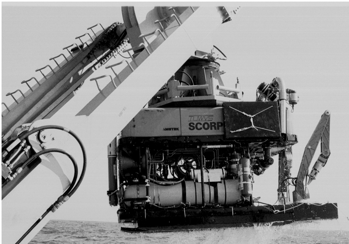
Abbildung 7: Das ROV "Scorpio" beim Bergen. Rechts erkennt man die beiden Manipulatoren und den Stahlrahmen, der die Lampen und die Videokameras trägt. In der Mitte sind die Telemetrie-einheiten und die Querpropeller sichtbar. Ganz links ist der senkrecht angebrachte Sender für die Respondernavigation erkennbar (Foto: N. v. Mirbach).
