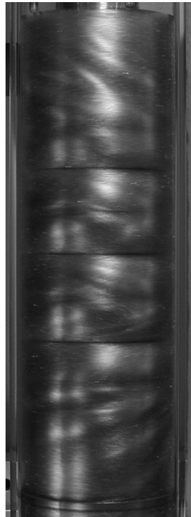
Abbildung 9.2: Sichtbarkeitsaufnahme der Twist-Mode bei Re_a = +150 und Re_i = 435 .
