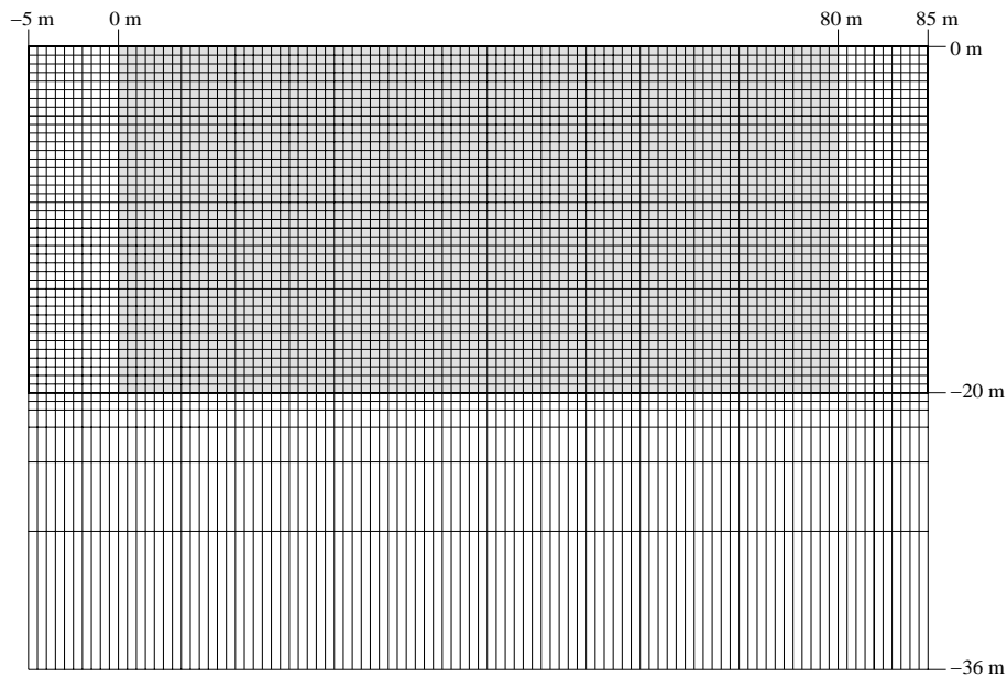
Abb. 4.1: Für die Modellierung verwendetes Gitternetz mit Randelementen (das Meßfeld ist grau und die Randelemente weiß hinterlegt).
