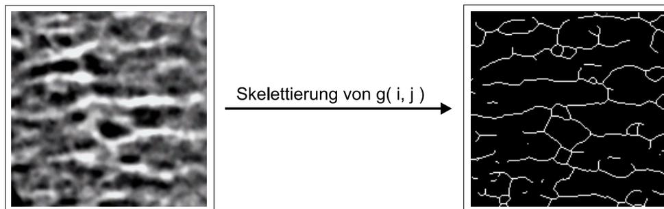
Abbildung 6.9: Beispiel eines globalen Operators anhand der Skelettierung einer ROI
