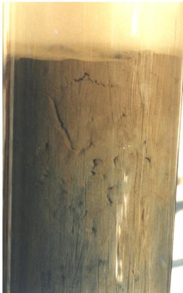
**Abbildung 37.** Sedimentkern der Station SR5 in 125 m Wassertiefe vom April 1997. Die Länge des abgebildeten Sedimentbereiches beträgt ca. 13 cm.
