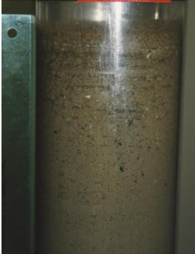
**Abbildung 14.** Sedimentkern von der Station 309MC in 608 m Wassertiefe. Die Länge des abgebildeten Sedimentbereiches beträgt ca. 13 cm.
