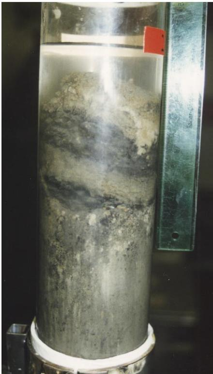
**Abbildung 22.** Kern von der Station 232V1K in 613 m Wassertiefe. Die Länge des abgebildeten Sedimentbereiches beträgt ca. 15 cm.
