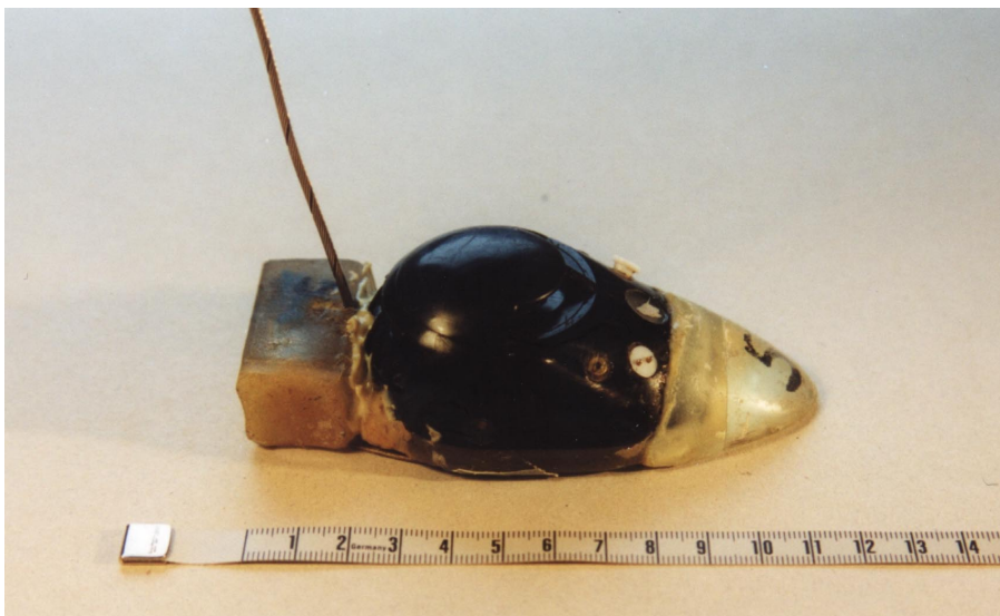
Abb. 3: Fahrtenschreiber-Radiotelemetriesender-Kombination (Mk6). Aus dem Telemetriesender ragt die im Bild abgeschnittene Antenne hervor.
