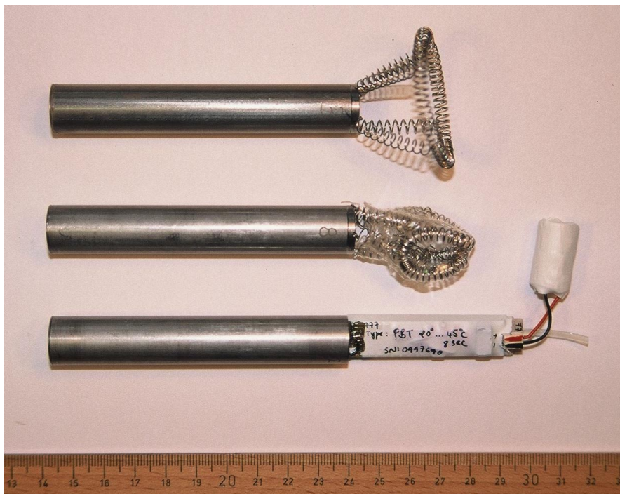
Abb. 7: Magentemperaturlogger: Oben: Gerät so, wie es im Magen des Pinguins vorliegt; offener Federring; Mitte: Federring in Gelatine verpackt; Unten: offener Logger mit zu erkennender Mikroelektronik. Weitere Details siehe Text.
