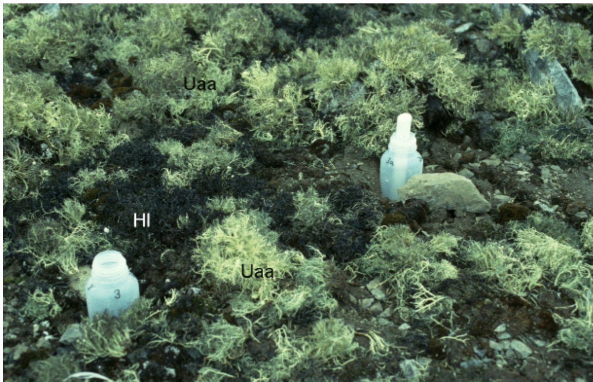
Abb. 2.15: Sammelflaschen zum Erfassen des Niederschlages an Standort 4 ( Himantormia lugubris (HI) und Usnea aurantiaco-atra (Uaa) gemischt), hinterer Sammler mit Stab ausgerüstet.
