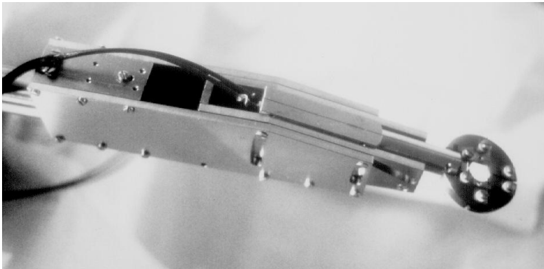
Bild 2.7: Manipulator-Kopf mit Flipmechanismus und aufgenommenem Probenhalter.
