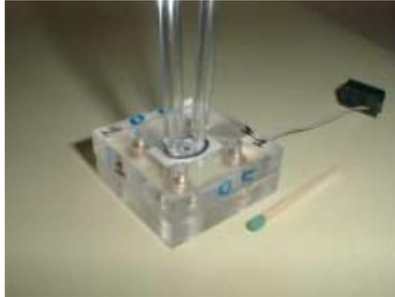
**Abb. 3.16:** Wechselküvette mit senkrechten Anschlüssen. Das Elektrodensystem ist in der Stirnfläche eingebaut.
