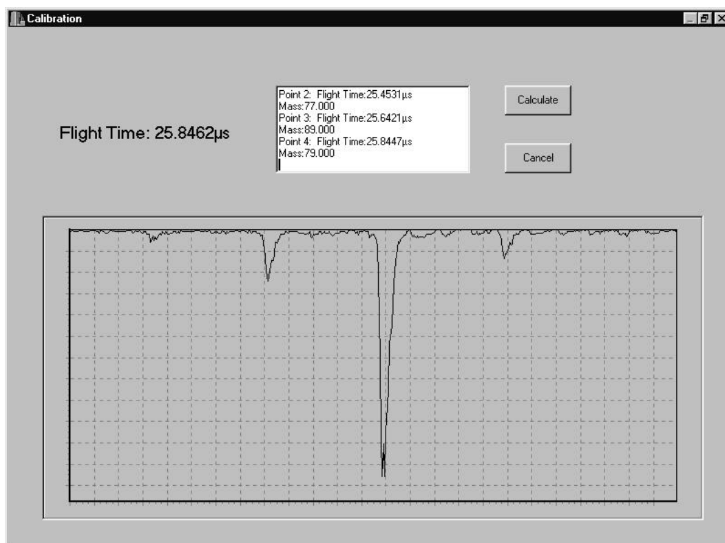
Abbildung 7.3: Kalibrierbildschirm zur Ermittlung der Parameter, die zur Umrechnung von Flugzeiten in Massenzahlen benötigt werden.
