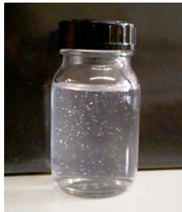
**Abb. 3.21** Aufnahme einer Mikroemulsion mit 50 Gew% wässriger 1,0 M CaCl<sub>2</sub>-Phase.
