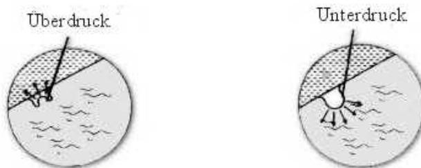
**Abb. 3.13** Schematische Darstellung der Kavitationswirkung [Quelle: WWW.ENTFETTUNG.DE].
