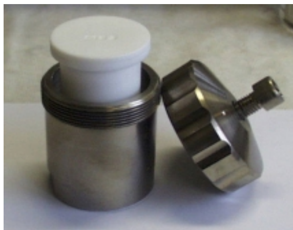
Abb. 2.1 Autoklav für statische Synthesen. Dosenkörper, Deckel mit Bohrung, Teflonbehälter
