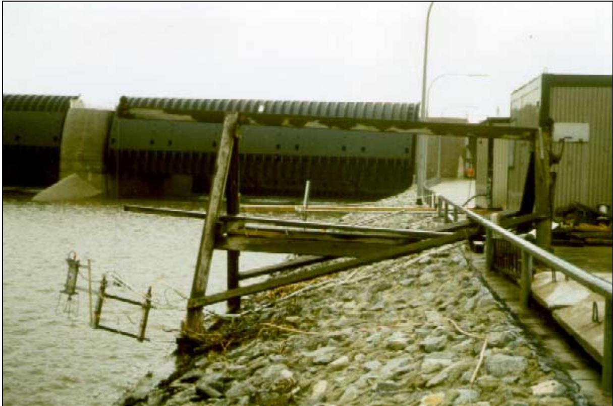
**Abbildung 22: Anordnung der Probeentnahme und des Strömungssensors**
