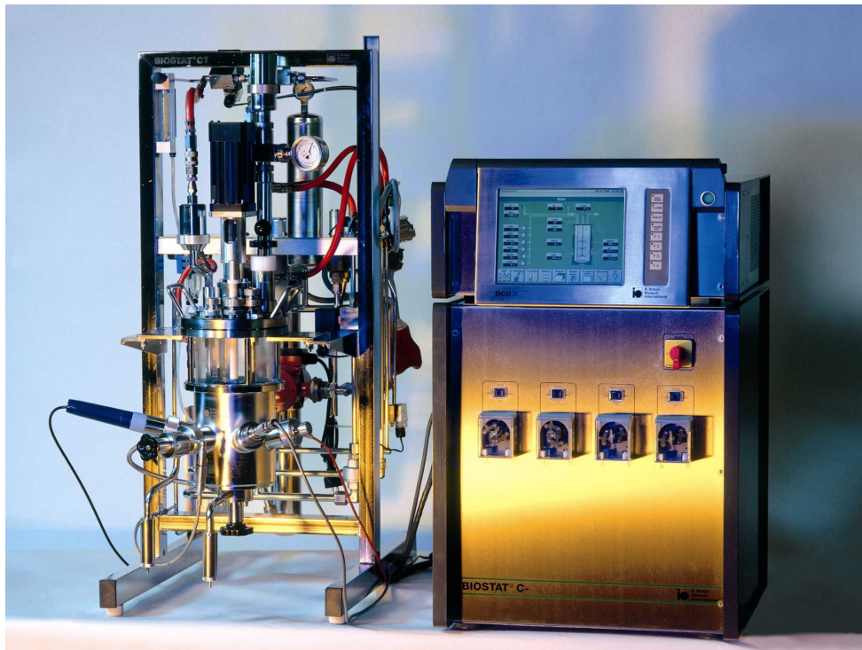
Bild 1.6: Für die Experimente eingesetzter Bioreaktor mit 2 l Arbeitsvolumen
