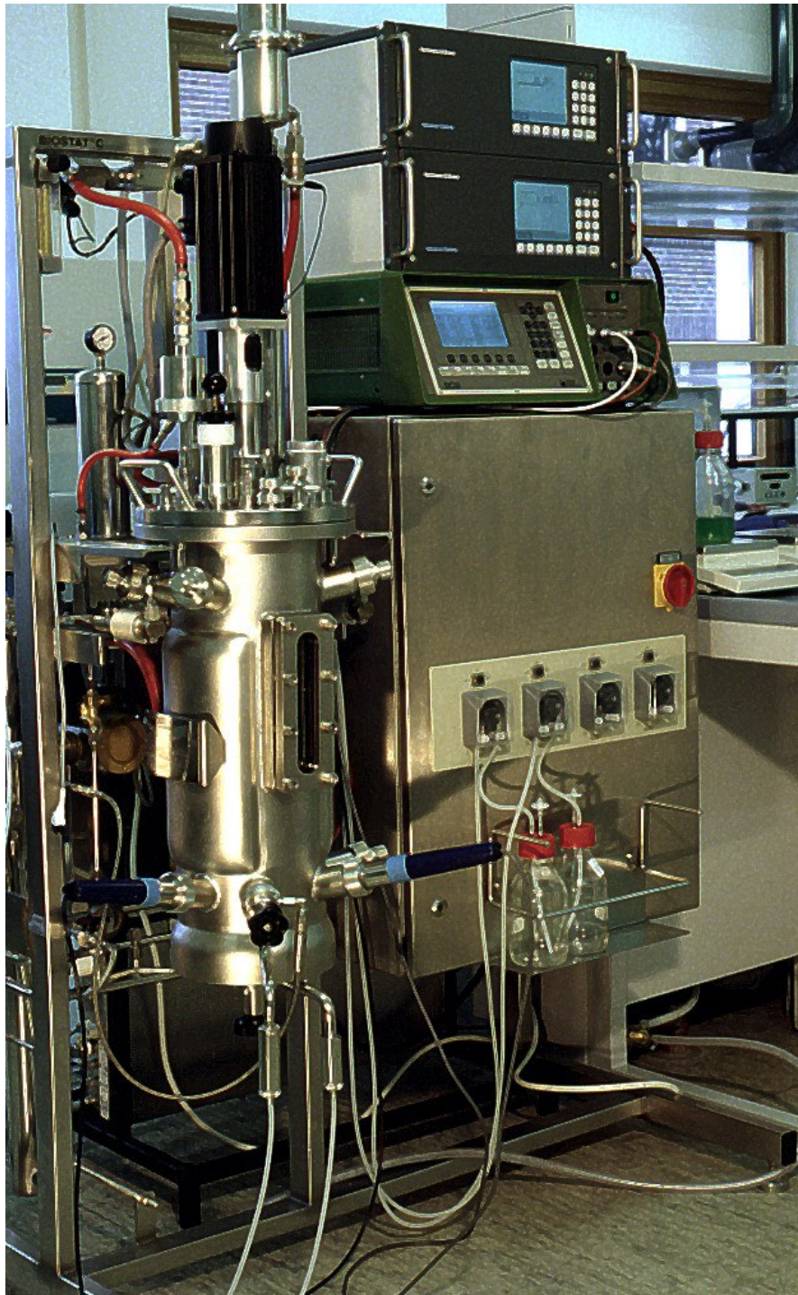
Bild 1.5: Für die Experimente eingesetzter Bioreaktor mit 10 l Arbeitsvolumen
