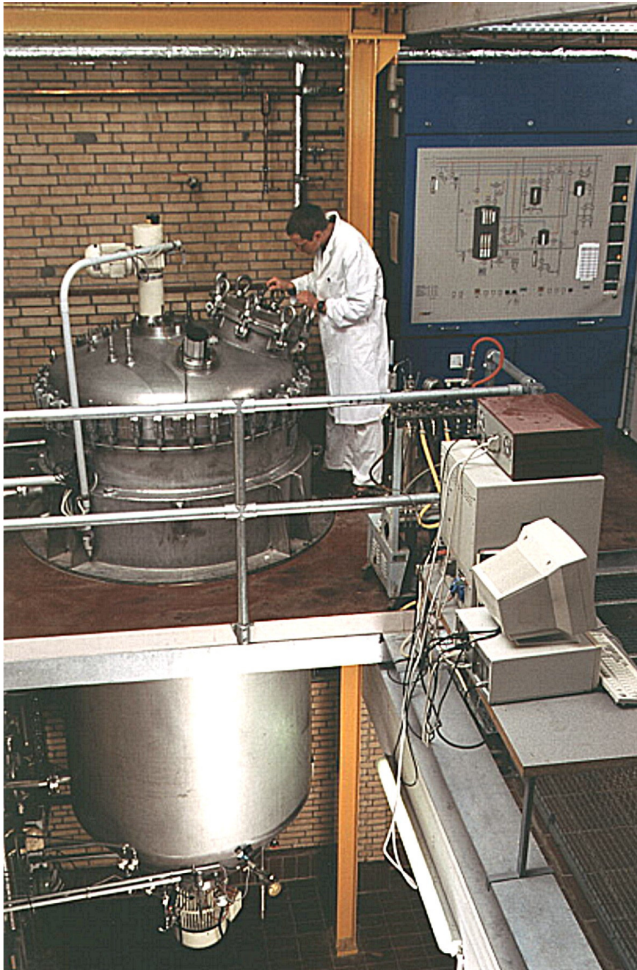
Bild 1.3: Industrieller Bioreaktor mit 3000 l Arbeitsvolumen zur Züchtung von entomopathogenen Nematoden
