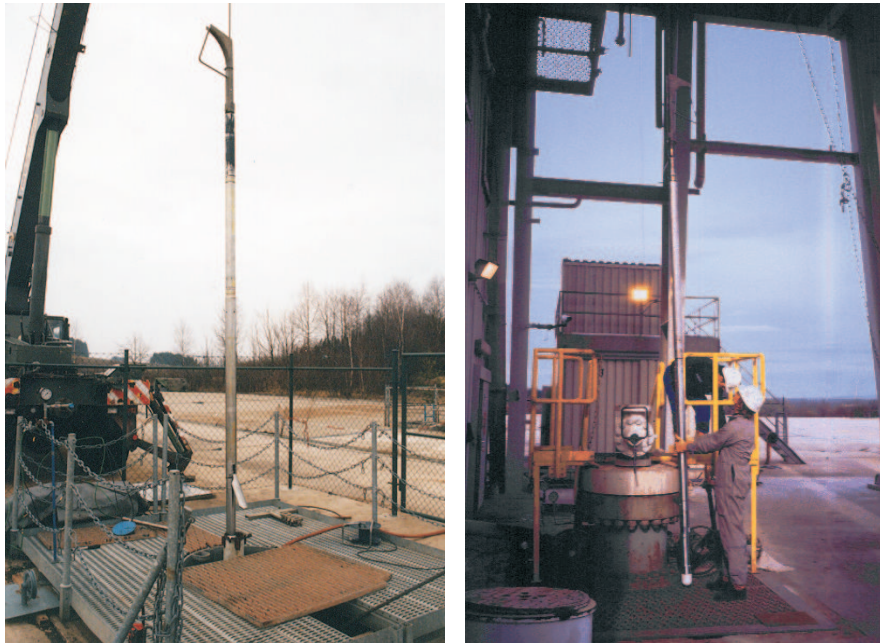
Abbildung 1.3: Bohrlochsonden an der KTB-Lokation in den Projekten "Seismologisches Tiefenlabor" und "Tiefes VSP an der Kontinentalen Tiefbohrung": links das Bohrlochseismometer BS-125 an der Vorbohrung, rechts die HP-/HT-Bohrlochsonde BG-250 an der Hauptbohrung.
