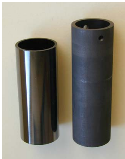
Abbildung 3.5: Aufnahme der zur Probenherstellung und in den Kugelfallexperimenten verwendeten Schmelztiegel. Links: Amorpher Kohlenstofftiegel der Fa. Sigradur. Rechts: Graphittiegel. Der Innendurchmesser des rechten Tiegels beträgt 39 mm und die Länge etwa 120 mm.
