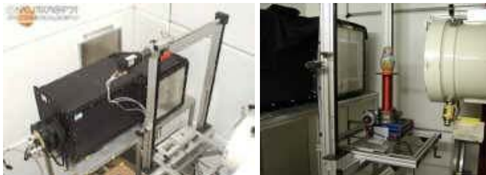
Abbildung 2.4: Experimenteller Aufbau in der Neutronentomographie des Paul Scherrer Instituts (Villigen, Schweiz). Links: CCD-Kamera. Rechts: CCD-Kamera, Probendrehtisch mit Probe und Kollimatorröhre. Die Höhe des Probentisches beträgt etwa 20 cm ( http://neutra.web.psi.ch ).
