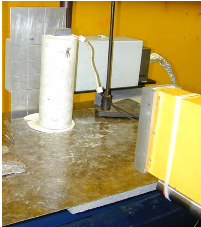
Abbildung 3.2: Kanthal-Widerstandsofen in der Neutronenradiographie am Laboratoire Léon Brillouin (Saclay, Frankreich). Zu sehen sind auch der Neutronenleiter (gelb) und der Detektor (graues Gehäuse). Die Höhe des Ofens beträgt 30 cm (Kahle et al. 2003a).
