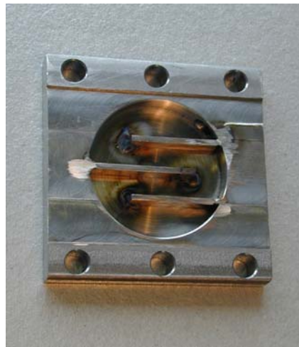
Abbildung 3.4: Aufnahme des Inneren einer Kühlplatte mit Stegen, die den Fließweg des Wassers verlängern und somit die Kühlleistung vergrößern. Die Abmessungen der Platte betragen 8 \times 8 cm 2 .
