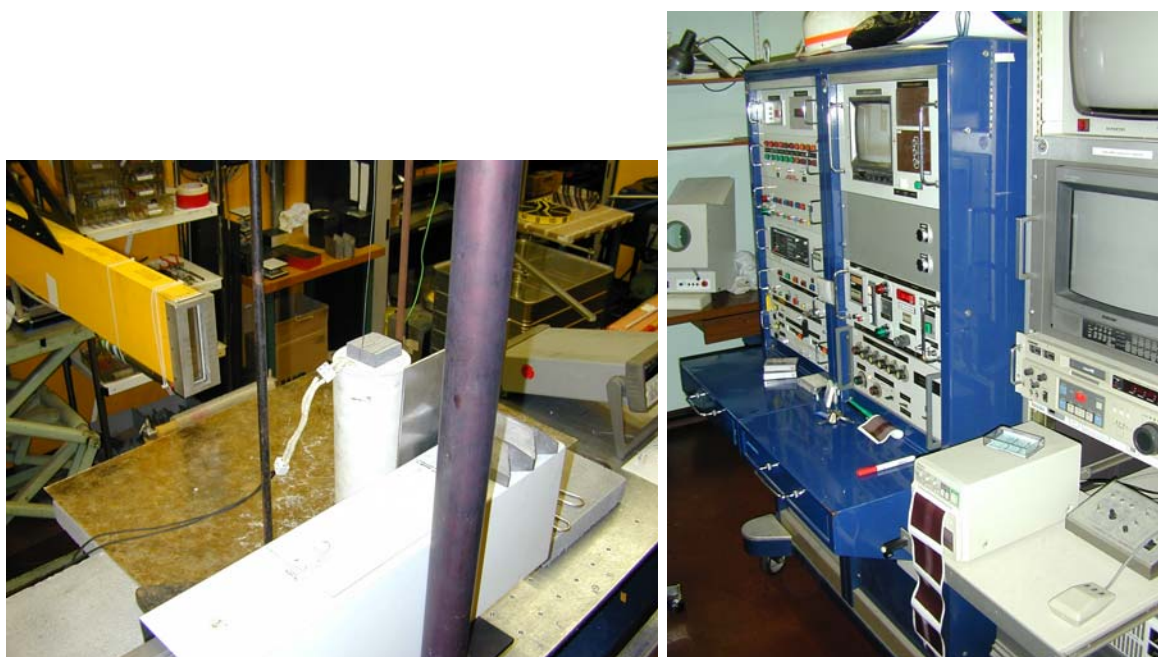
Abbildung 2.2: Experimenteller Aufbau in der Neutronenradiographie am Laboratoire Léon Brillouin, Saclay, Frankreich. Links: Neutronenleiter (gelb), Ofen (Bildmitte) und Detektor (grauer Kasten im Vordergrund). Rechts: Kontrollraum mit Videoanlage.
