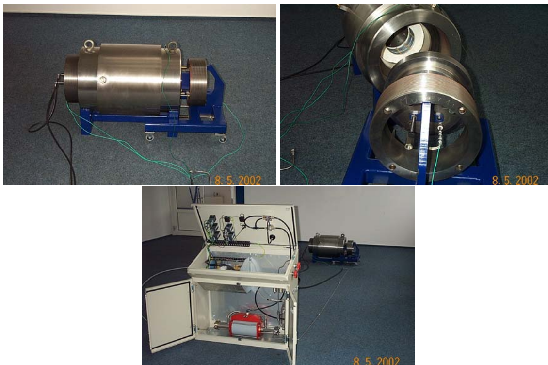
Abbildung 3.6: Links oben: Hochdruckautoklav. Die Durchstrahlrichtung der Neutronen liegt in Längsrichtung des Autoklavs. Die Abmessung des Autoklavs in dieser Richtung beträgt 1 m; das Gewicht liegt bei 400 kg. Rechts oben: Geöffneter Autoklav mit Sicht auf die Heizwendel. Unten: Steuerpult und Autoklav.
