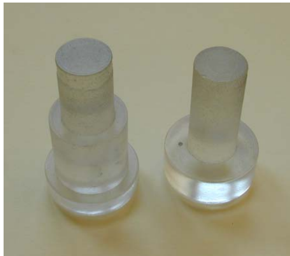
Abbildung 4.5: Aufnahme der erkalteten Proben zur Anwendung des Faxén-Korrekturfaktors. Das Probenmaterial besteht aus N-KF9-Glas. Links eine Probe mit zwei Stufen, rechts eine mit einer Stufe.
