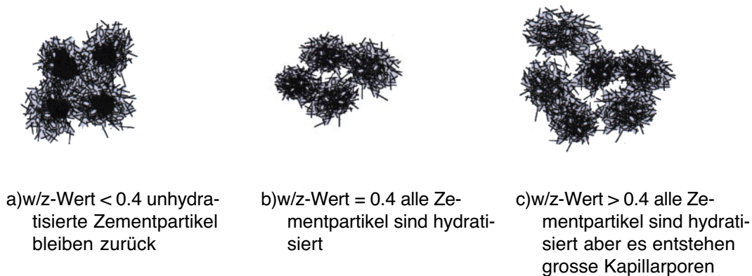
Abb. 2.2: Der Einfluss des Wasser/Zementverhältnis auf das Gefüge des Zementleimes nach van Mier (van Mier 1997)
