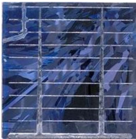
Abbildung (4-20): Die Solarzelle nach der Isolierung der oberen linken Ecke
