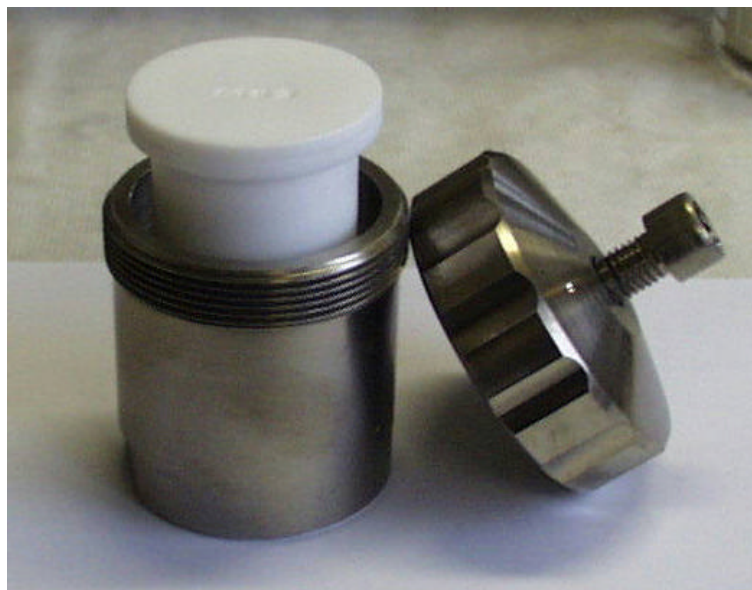
Abb. 2.1 Stahlautoklav mit innen liegendem Teflon-Reaktionsgefäß
