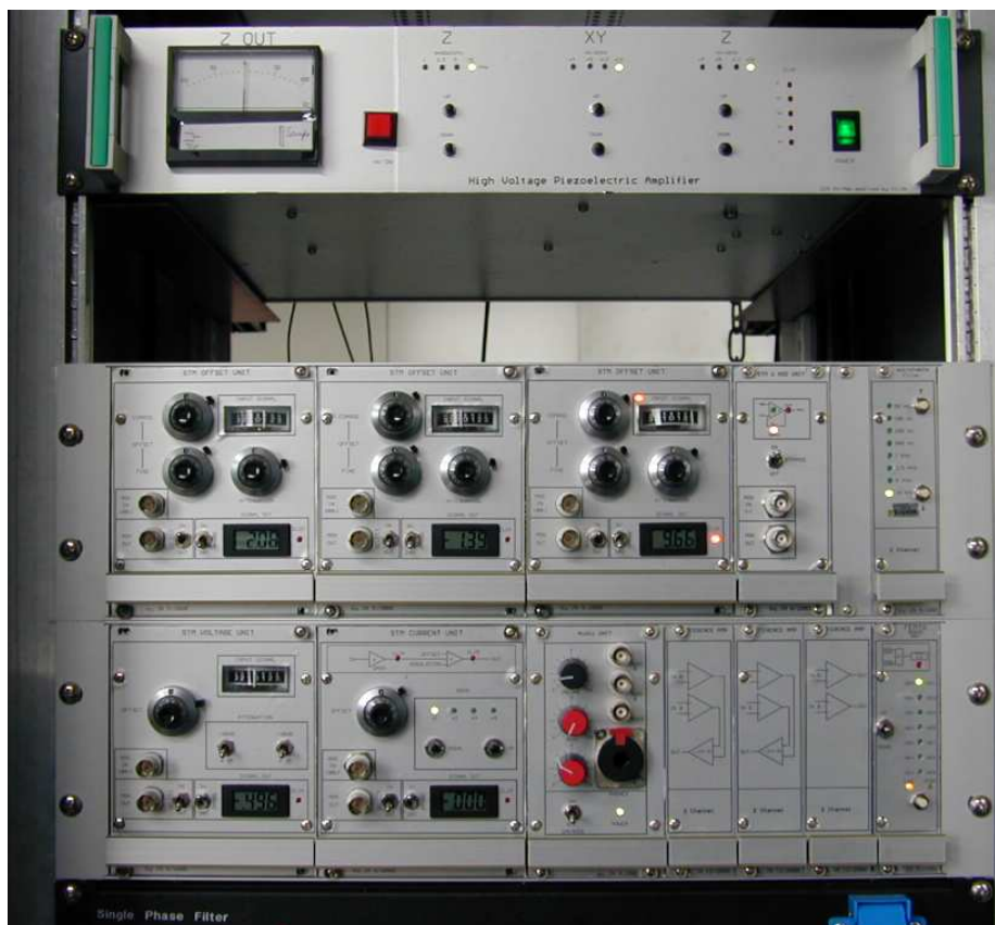
Abbildung 3.27: Die neuen Komponenten der STM-Elektronik: Oben: der modifizierte Hochspannungsverstärker, Mitte und Unten: Die zusätzlichen Module zur Rauschunterdrückung und Auflösungserhöhung.
