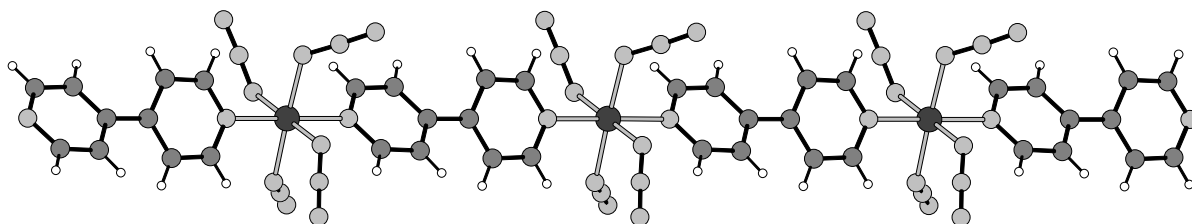
Abb. 5.18: Kristallstruktur von Poly[di-( \mu_2 -Azido-N,N')-di-( \mu_2 -4,4'-Bipyridin-4,4')-Natrium-Eisen(II)] mit Blick auf die Fe-Ketten entlang der kristallographischen a-Achse (Fe = ●, N = ●, C = ●, H = ○).
