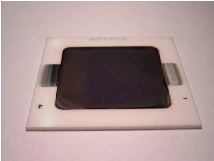
Abbildung 6.16: Das Foto zeigt eine auf  $\text{Al}_2\text{O}_3$ -Substrat aufgebrachte Dünnschichtzelle. Die Substrate besitzen eine Abmessung von 40 x 40 mm und eine Dicke von ca. 2 mm. Die Fläche der Dünnschicht-Batterie beträgt 2,6 x 2,6 cm.
