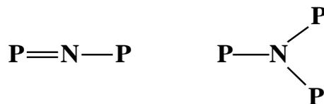
Abbildung 4.1: Durch Zugabe von Stickstoff in  $\text{Li}_3\text{PO}_4$  verbessert sich die Ionenleitfähigkeit. Wahrscheinlich ist dies durch die Bildung von Seitenverzweigungen des Phosphors zum Stickstoff begründet [36].
