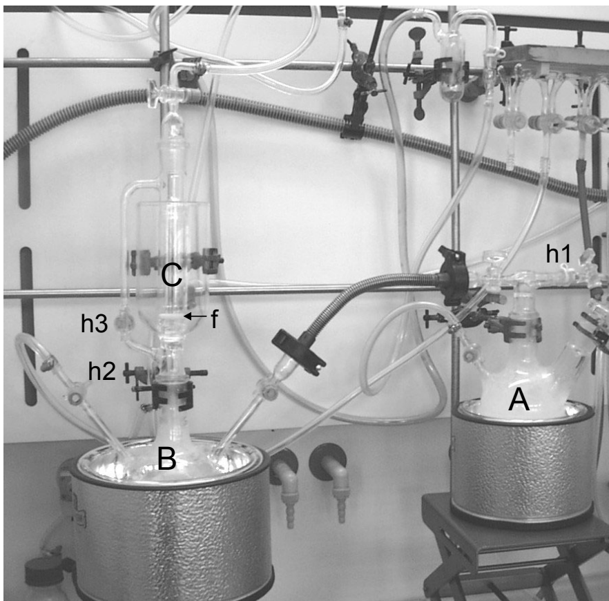
Abb. 3.1: Apparatur zur Darstellung der Alkalimetallsulfide [98].
