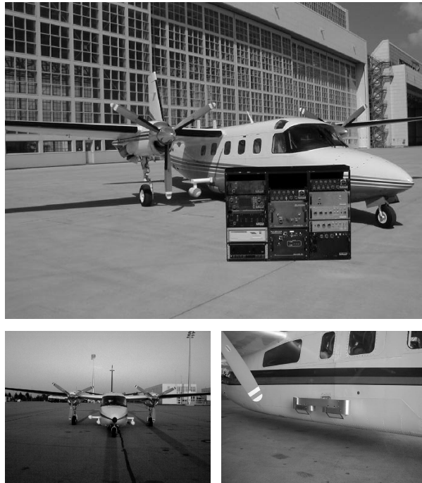
Abbildung 3.11: AES-1 Flugsegment und Antennenkonfiguration im CT- und AT-Betrieb.
