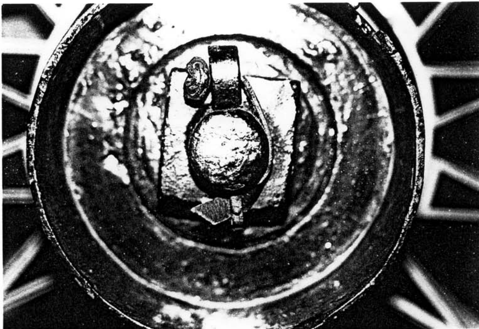
Abb. 192: St. Gotthard-Postkutsche. Detail von der Radnabe; der Radvorstecker wird mit einem Lederriemen mit Schlaufenknoten gesichert (Landesmus. Zürich; Photo: J. Leskovar).
