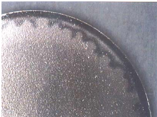
Abbildung 5-6: Aufnahme einer mit Silber besputterten Keramikprobe nachdem ein Lecktest an ihr durchgeführt wurde. Es sind keine Beschädigungen erkennbar. Vergrößerung 2,5x.
