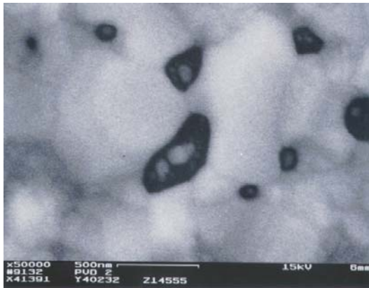
Abbildung 4-13: Hochaufgelöste REM-Aufnahme von Probe 2: Die Präparationsbedingungen sind Tabelle 4-5 zu entnehmen. Benachbarte große Silberpartikel schließen Poren mit kleinen Silberpartikeln in ihrem Zentrum ein - durchschnittliche Porengröße ca. 250 nm, Vergrößerung 50.000x.
