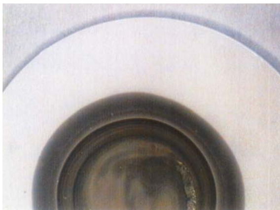
Abbildung 6-12: Aufnahme eines Keramiksubstrates nach mehrfachem Aufsetzen und Eindampfen eines Tropfens der AgNO 3 -Lösung. Es hat sich ein System konzentrischer Ringe gebildet, deren unterschiedlicher Färbung mit der Silberkonzentration an der Oberfläche zusammenhängt.
