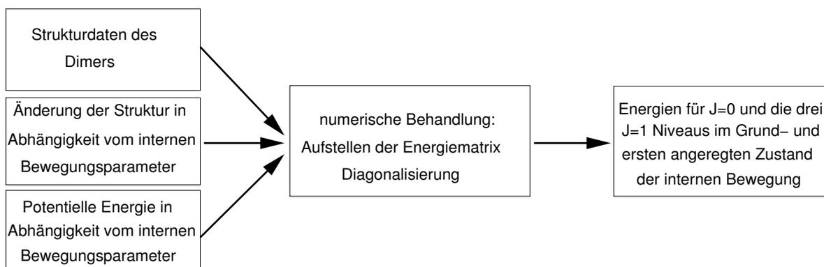
**Abbildung 4.5:** Blockdiagramm zum Algorithmus des Programms *fmx0*
