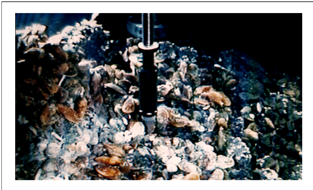
Abbildung 6. oben: Hydro Bottom Station (nach HALBACH et al. 2001), unten: Probennahme mit der Hydro-Lanze an einer mit Muscheln besiedelten warmen Quelle im Nord-Fiji-Becken.
