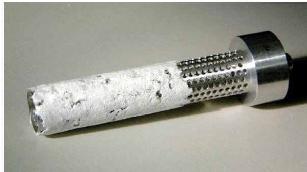
Abbildung 4.10: Die Probe für die Messungen am Flugzeitspektrometer FOCUS. Das Probenmaterial wird mit einer Lage Aluminiumfolie (hier nicht gezeigt) auf dem Hohlzylinder fixiert. Deutlich zu erkennen sind die Löcher, die eine Deuterierung der Probe ohne einen Ausbau aus dem Probenbehälter ermöglichen.
