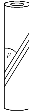
Abbildung 1.6: Definition des Mikrofibrillenwinkels \mu als Steigungswinkel der Helix, die die Mikrofibrillen in der Pflanzenzellwand bilden.
