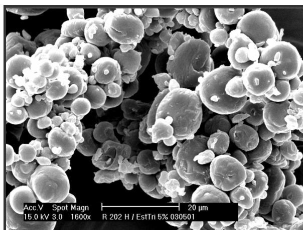
Abbildung 4.3: Resomer ® R 202 H Mikropartikel beladen mit 5% Estrioltriacetat; x90-Wert: 13 µm
