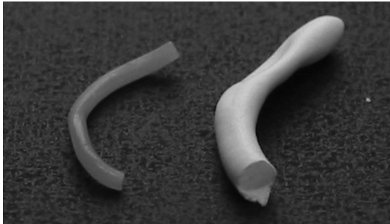
Abbildung 2.36: Extrudate von P-b-D,L-(laktid-co-glykolid) 75:25 (Mw: 51800), vor Abbau und nach 100 Tagen
