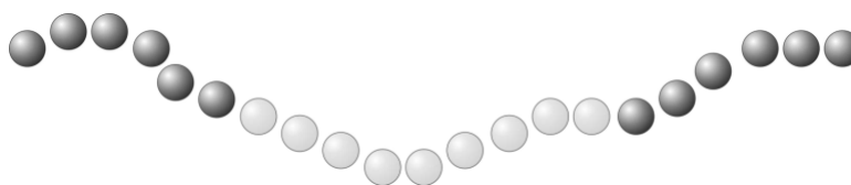
Abbildung 2.1: Schematischer Aufbau eines ABA-Blockpolymers (nach Stridsberg et al. 2002)
