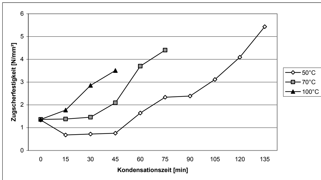
Abb. 4-9: Einfluss der Kondensationstemperaturen auf die Kondensationszeit und auf die optimalen Festigkeiten der Ligninsulfonatverklebungen
