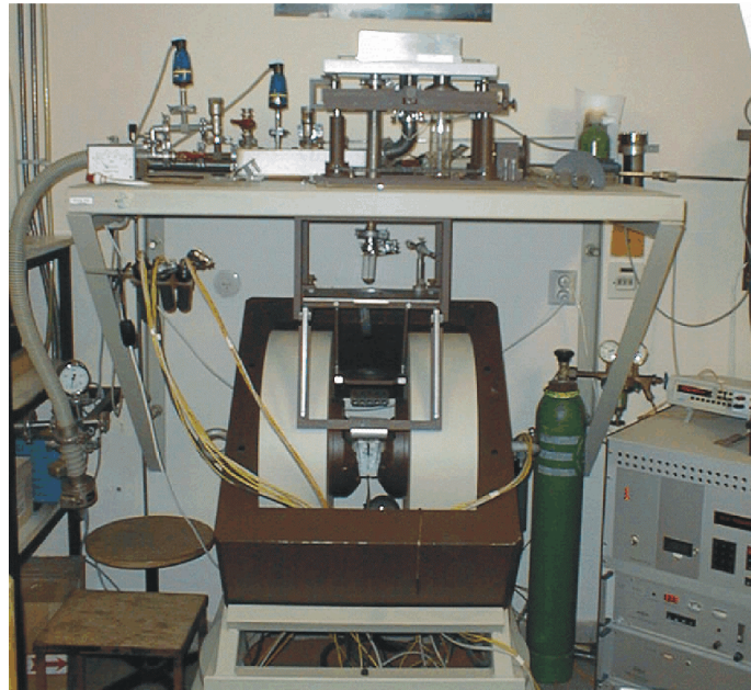
Abbildung 14: Verwendete Faraday-Magnetwaage (Bruker, Karlsruhe, http://www.uni-kiel.de/anorg/bensch/bensch.htm ).
