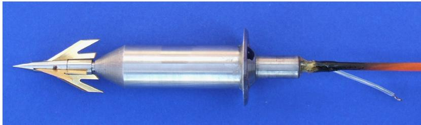
Abb. 10. Gehäuse und Befestigungsmechanismus des implantierbaren Kurzwellen-Radiotransmitters, der 1999 in der Lagune San Ignacio zur Besenderung von Grauwalen verwendet wurde. Die Konstruktion besteht aus der Verankerungsspitze und dem Sender im Edelstahlgehäuse.
