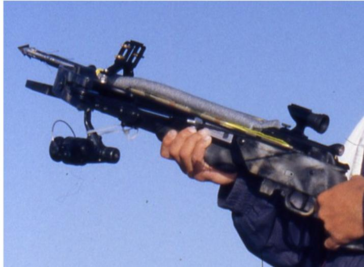
Abb. 16. Besenderungstechnik von implantierbaren Satellitensendern mit Hilfe einer Armbrust. Sender und der Pfeilschaft mit Auftriebskörper sind miteinander verbunden. Der Pfeil ist durch eine Sehne gesichert.
