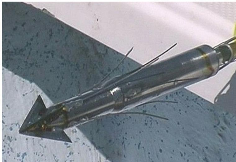
Abb. 14. Gehäuse und Befestigungsmechanismus des voll implantierbaren, kapselförmigen Satellitensenders, der in der Wintersaison 1999 in Lagune San Ignacio zur Besenderung von Grauwalen verwendet wurde.
