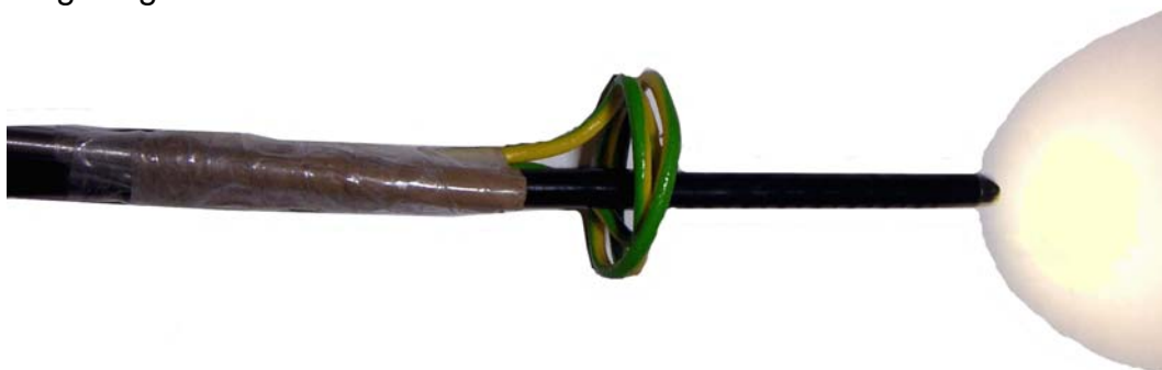
Abbildung 5.9: Stützkonstruktion zur Fixierung der Mittellage des Endoskops oberhalb der Herzklappe.
