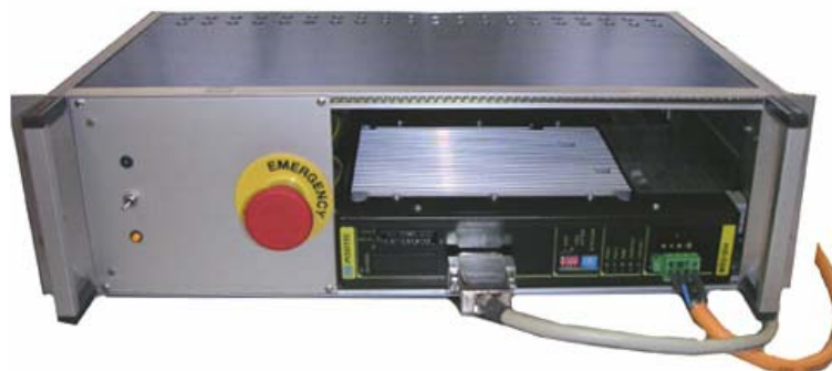
Abbildung 3.19: Schrittmotor-Leistungselektronik und Stromversorgung mit Not-Aus Funktion.
