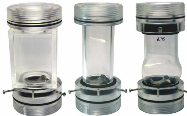
Abbildung 3.14: Verschiedene Einsätze für die Rohrstrecke in Strömungsrichtung direkt nach der Herzklappe.
