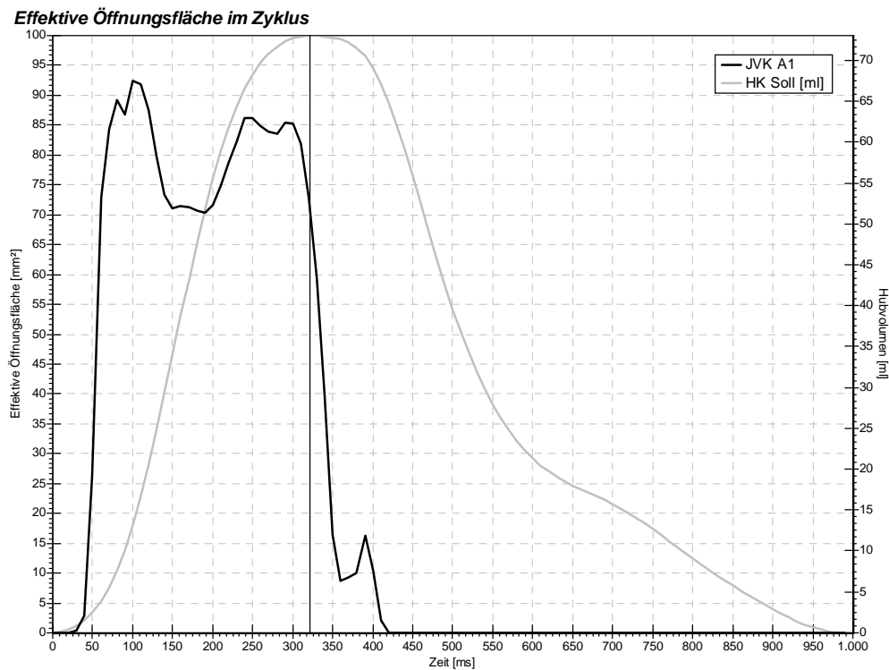
Abbildung 8.18: Zeitlich aufgelöste Darstellung der Öffnungsfläche, entsprechend der Bilderreihe in der vorherigen Abbildung.
