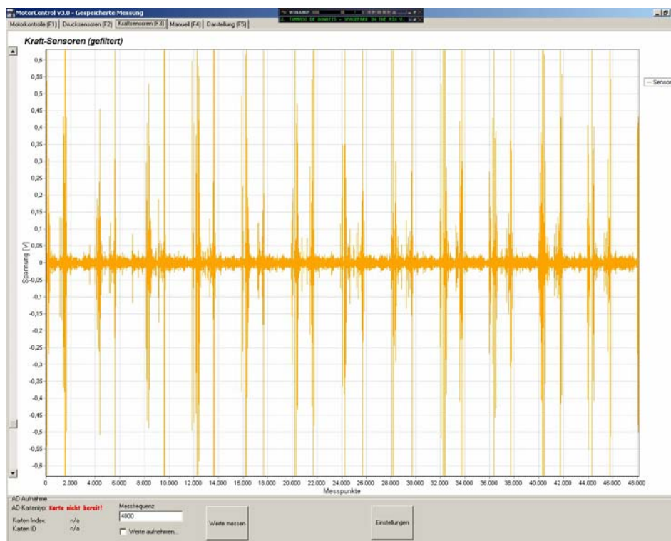
Abbildung 3.40: Kalibrationssignal der Piezokraftsensoren bei einer Federauslenkung von maximal 6 N und einer Periodizität von 3 Hz.
