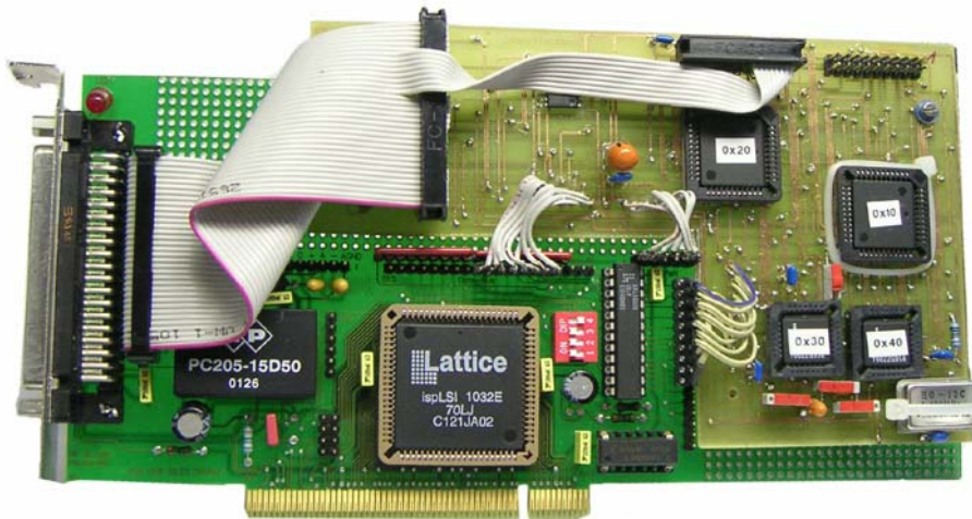
Abbildung 3.26: Die Platine der PCI-Einsteckkarte zur Schrittmotoransteuerung.
