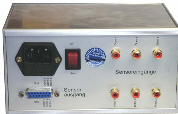
Abbildung 3.31: Verstärkermodul zur Aufwertung der Signale der Kraftsensoren.
