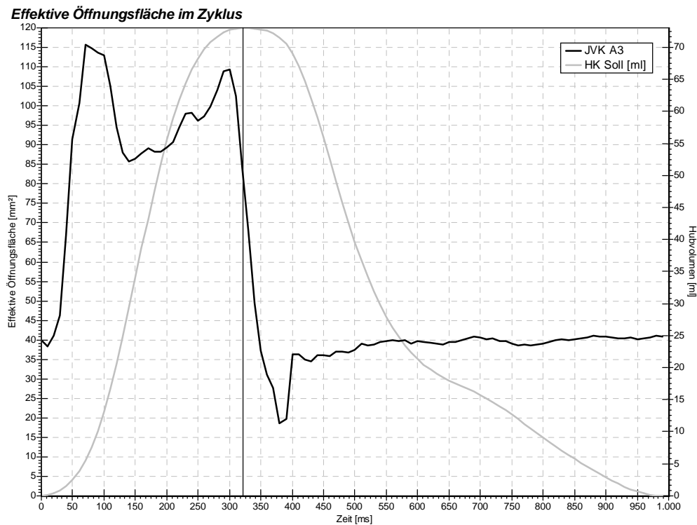
Abbildung 8.23: Zeitlich aufgelöste Darstellung der Öffnungsfläche, entsprechend der Bilderreihe in der vorherigen Abbildung.
