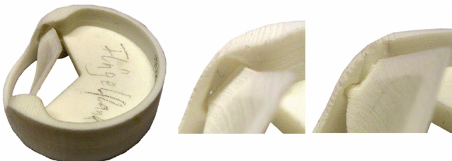
Abbildung 4.2: Darstellung der 3:1 Modelle der ersten Baureihe. Vlnr: Freigleitendes Lager in der Übersicht und im Detail, Stiftlager im Detail.
