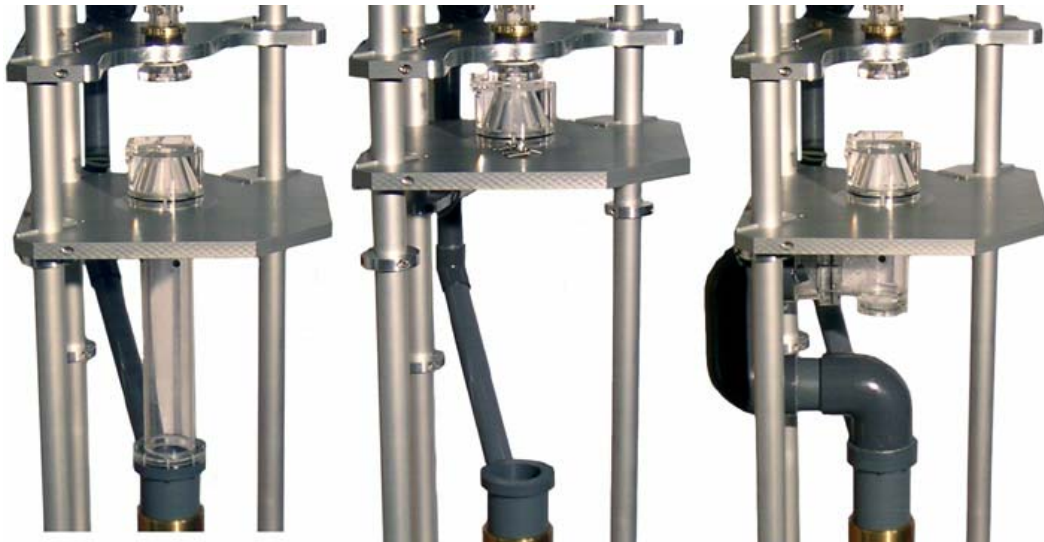
Abbildung 3.7: Prinzip des Wechsels des Rohres zur Anströmung der Herzklappe. (vlnr: Gerader, ohne und U-förmiger Rohreinsatz).
