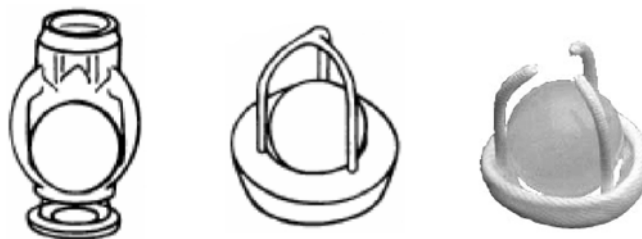
Abbildung 2.6: Ballklappen.: l. Hufnagel, m. u. r. Starr-Edwards
