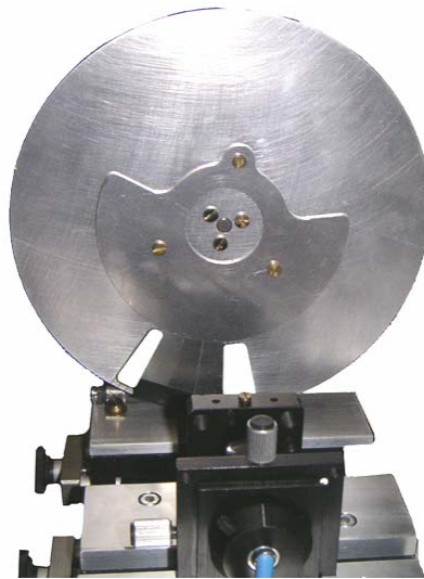
Abbildung 3.36: Prinzip der variablen Chopperscheibe.
