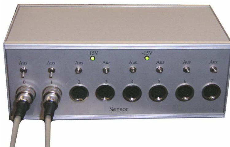
Abbildung 3.29: Die Verteilerbox der Drucksensoren.
