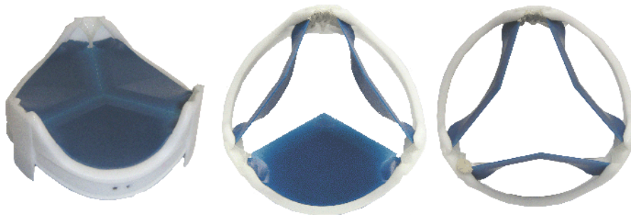
Abbildung 4.4: Darstellung des dreiflügeligen 3:1 Modells der zweiten Baureihe in verschiedenen Öffnungspositionen.
