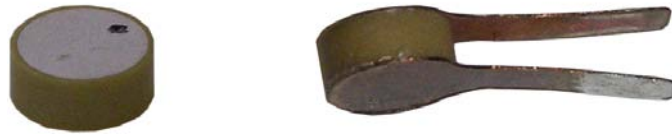
Abbildung 3.30: Zylindrische Piezokeramik zur Erfassung der Kräfte. Links ohne, rechts mit angebrachten Lötflanschen.
