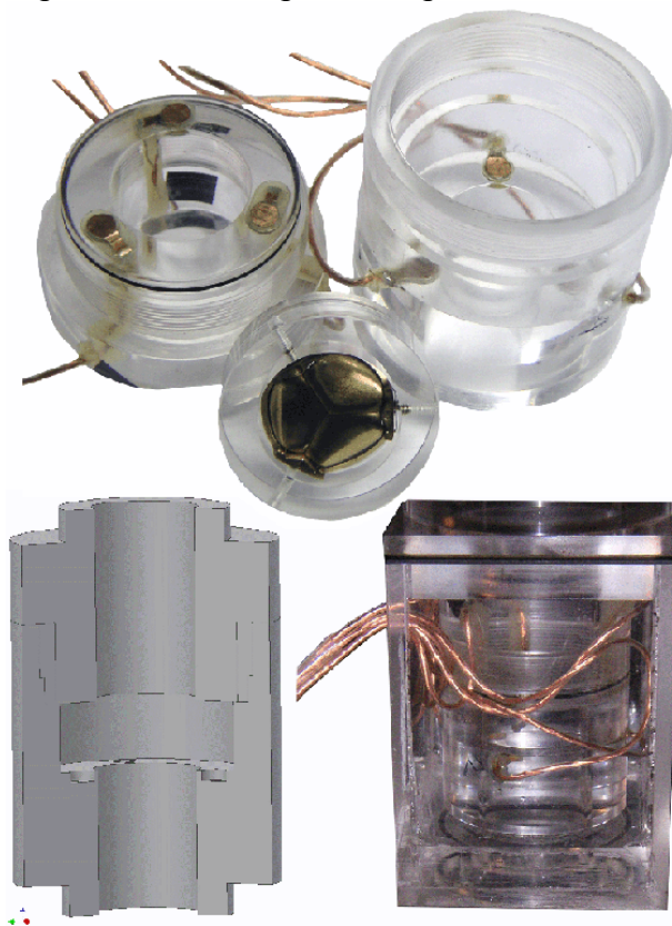
Abbildung 3.16: Kraftmessbulbus, schematische und reale Abbildung.
