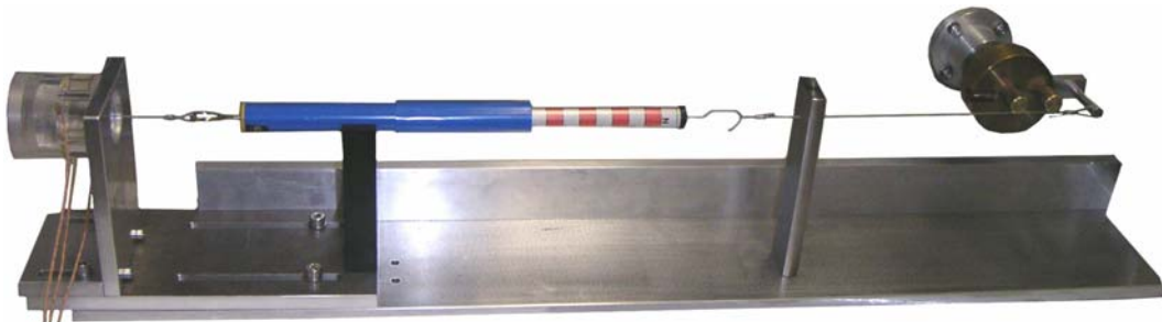
Abbildung 3.37: Aufbau zur Kalibration der Kraftsensoren.
