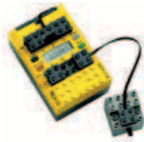
Abb. 2: Mikrocomputer RCX mit Motor (LEGO)
