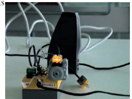
Abb. 6: Mikrocomputer RCX mit Motor und Infrarotsender
