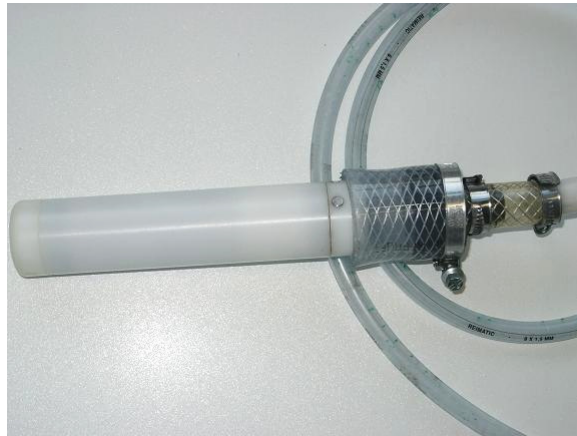
Abbildung 12: Bolus mit aufgesetztem Druckadapter
