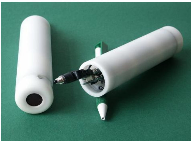
Abbildung 4: Bolus (links: geschlossen, unteres Ende mit Gummimembran; rechts: geöffnet, mit Schlafstecker)
