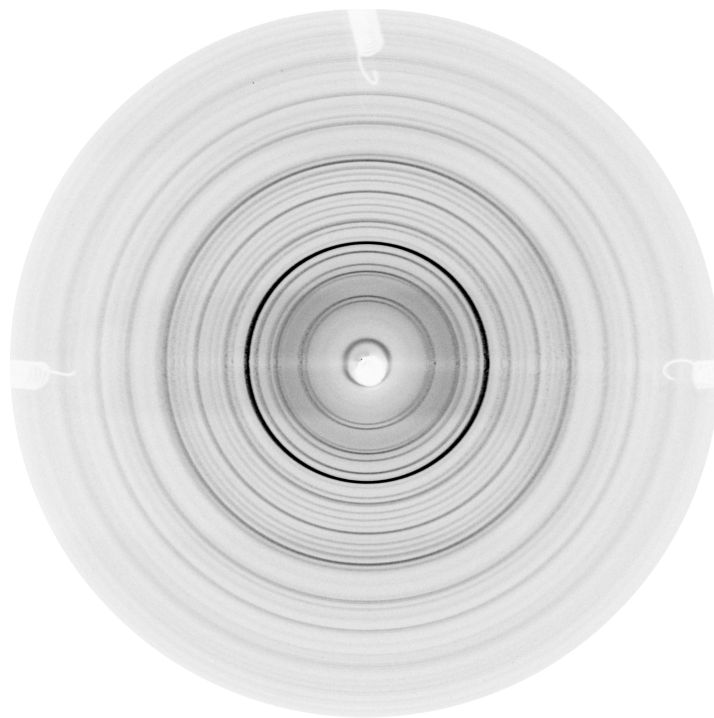
Abbildung 5.1: Zweidimensionales Pulverdiffraktogramm von \text{TbCaAl}[\text{Al}_2\text{O}_7] (Melilith-Strukturtyp) bei T = 1109(11) K, aufgenommen am MAR2000 -Bildplattendiffraktometer.
