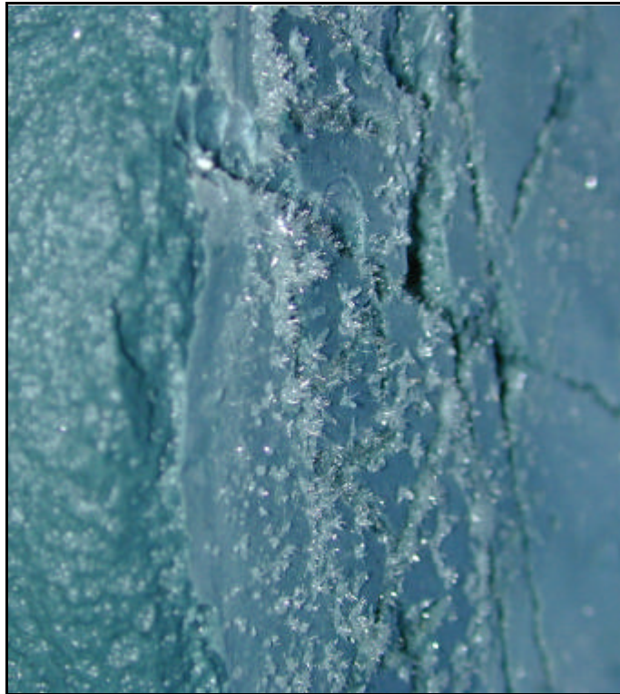
Abb.II.3: Lagerung in einer kombinierten Magnesium-/Sulfatlösung. Prüfkörper der Dichtwandmasse Na-230 mit oberflächlichen Mineralneubildungen nach 28 Tagen Lagerungsdauer. Mg^{2+} -Konzentration: 1.000 mg/l; SO_4^{2-} -Konzentration: 7.500 mg/l.
