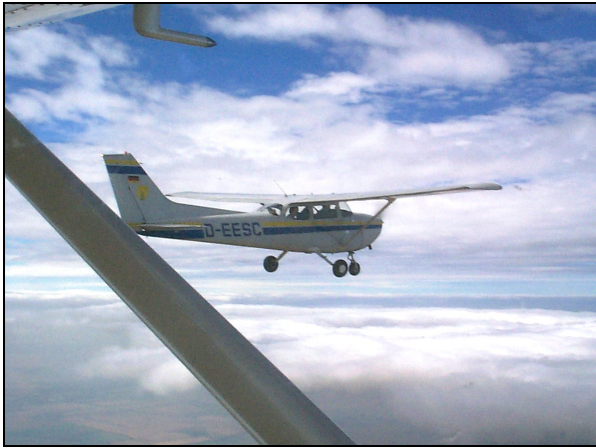
Fig. 85 C172: typische Merkmale: abgestrebter Hochdecker, große Leitwerksflosse bis fast zum Heckfenster reichend, starres Bugfahrwerk, an der Zahl der seitlichen Fenster ist grob der Typ ablesbar. Vorliegende Abb. zeigt eine C172 im Verbandsflug mit einer zweiten C172 (beides Maschinen von R. Krüger ARDEX GmbH/Flugplatz Kyritz). Das Bild entstand wenige Minuten vor der totalen Sonnenfinsternis 1999, ungefähr auf der geographischen Breite von Berlin in etwa 2500 m Höhe (Piloten: R. Beator, G. Winkler).
