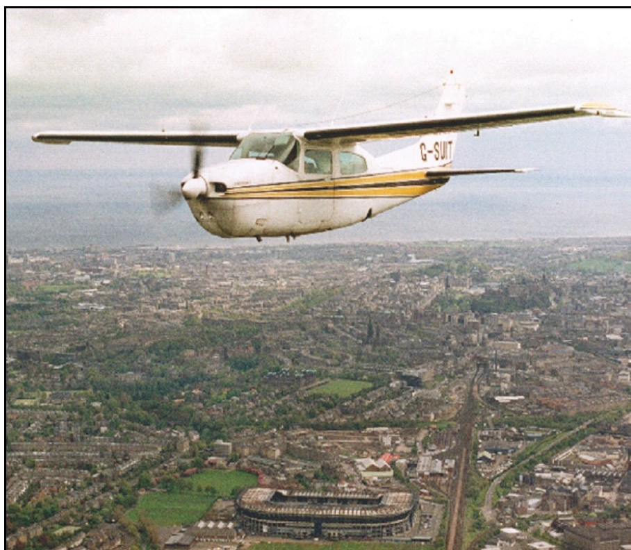
Fig. 136 Eine von privat gecharterte Cessna 185RG (RG: Retractable Gear), die für die schottische RCAHMS fliegt. Die Maschine ist voll instrumentenflugtauglich – man erkennt das an der Windschutzscheibenteisungsvorrichtung vor dem Piloten. (Crown Copyright: RCAHMS)
