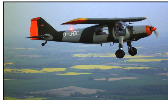
Fig. 90 Do27 des Luftsportvereins Kiel (ehemaliges Verbindungs- und Beobachtungsflugzeug, Bj. 1958, Reichweite: 800 km; (Quelle: www.lsv-kiel.de , 2005)
