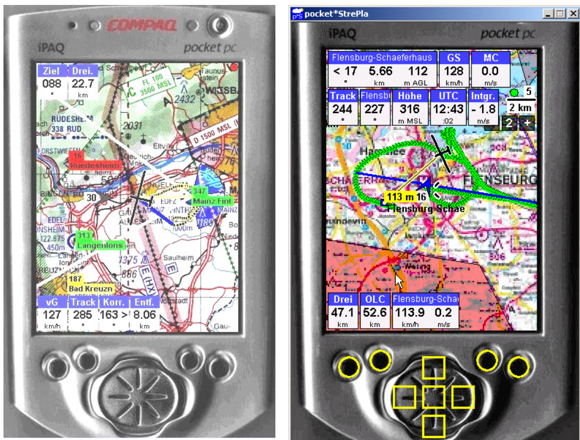
Fig. 151 Der Compaq iPaq als Grundlage für ein Moving-Map-System. Links abgebildet ist ein Foto vom Firmenserver (8F Computer), rechts ein Bildschirmfoto vom Rechner des Autors: Gezeigt wird ein iPaq-Simulatorprogramm, das sich über das Hauptprogramm „Strepla“ starten lässt.(2005)
