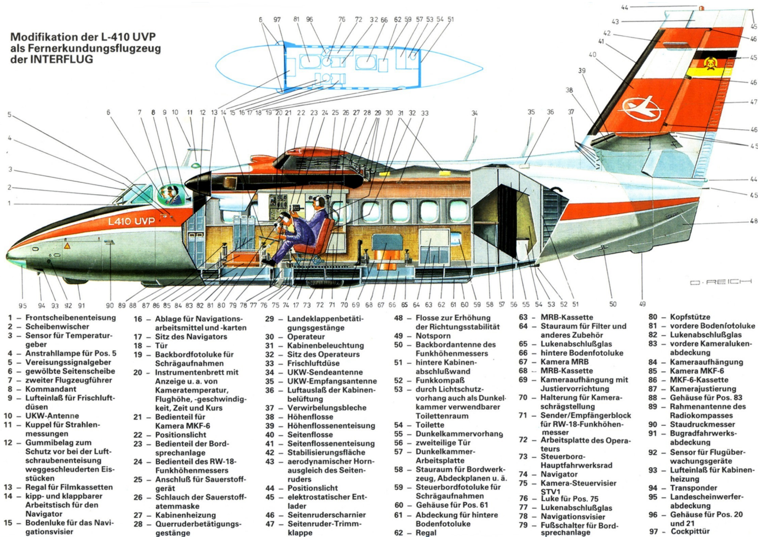
Fig. 80 Derselbe Flugzeugtyp in einer Funktionalgliederung dargestellt (Zeichnung: O. Reich für FliegerRevue Ausgabe Nr. 8/1986, mit freundlicher Genehmigung FliegerRevue , 2005)
