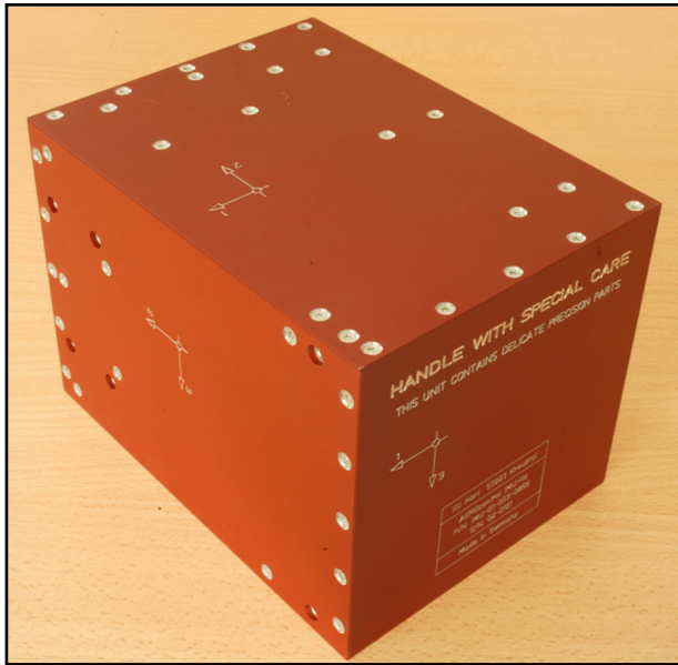
Fig. 176 Beispiel einer IMU (AeroControl-II, basierend auf LITEF-Komponenten, mit freundlicher Genehmigung von Firma IGI, 2005)
