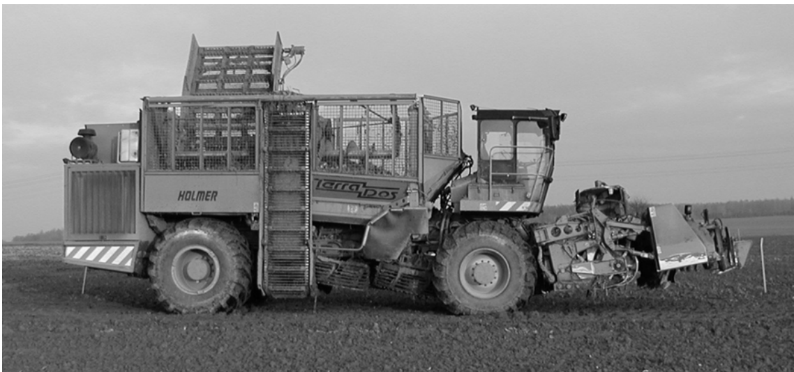
Abbildung 3-3 Holmer Terra Dos, 6 reihiger Köpfrodebunker, Gewicht halbbeladen ca. 35Mg
