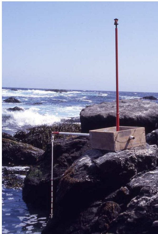
Abb. 2.5: Der Prisma-Apparat mit Prismastab (rechts) und Lotleine (links), einzementiert auf einen Felsen unterhalb des Beobachtungsstandortes auf der Insel Choros.
