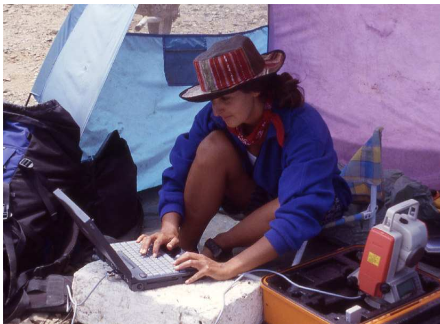
Abb. 2.9: Die Daten des Theodolits wurden jeden dritten Tag auf einen PC übertragen.
