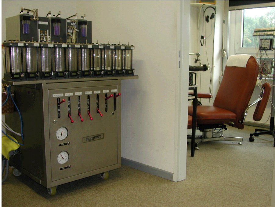
Abbildung 4.1: Olfaktometer der Firma Burghart, links: Gerät mit Duftkammern, rechts: Kopfstück mit Teflonstutzen und Entspannungstuhl
