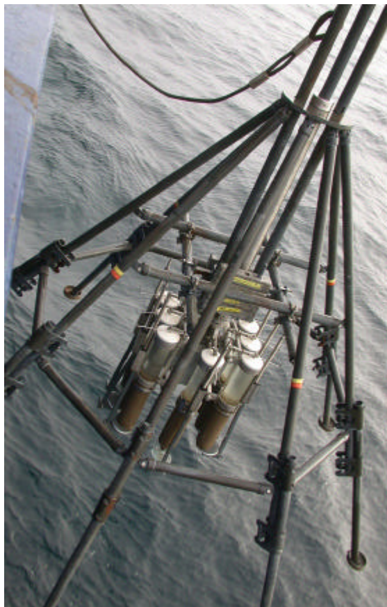
Abb. 7: Probennahme während der Reise ARK XIX/4a mit Hilfe eines Multicorers.
