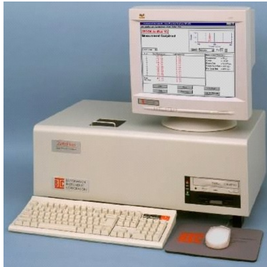
Abbildung 4.14: Foto eines betriebsbereiten BIC Zetaplus® zur Bestimmung von Teilchengrößen und Zetapotentialen in Dispersionen
