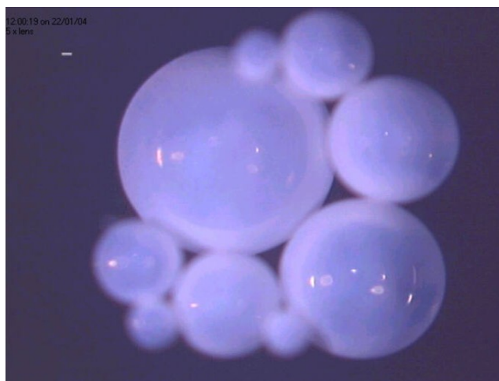
Abbildung 4.10: Nahaufnahme der feststoffstabilisierten Luftblasen, Ausdehnung des Blasenhaufens beträgt etwa 1,3 mm
