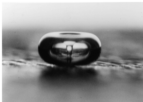
Abbildung 3.12: Implodierende akustische Kavitationsblase in der Nähe eines Substrates [27]
