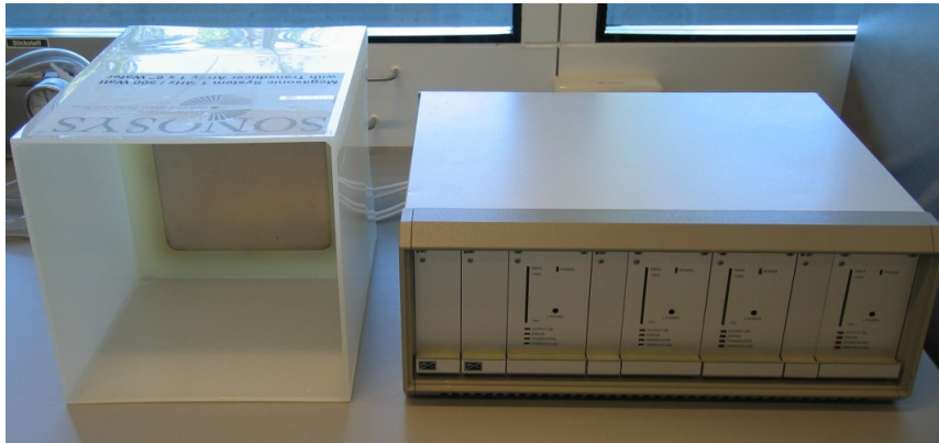
Abbildung 7.20: Sonosys Ultraschallbad mit vier Piezokristallen und Generator mit 1000 Watt elektrischer Aufnahme und 1 MHz Erregerfrequenz
